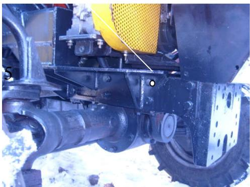
**Рисунок 5. Крепление стоек на лонжероны.**
